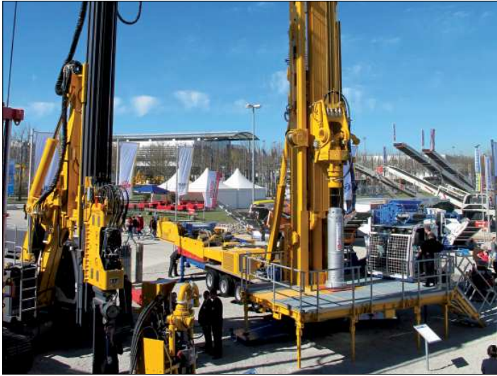
Mit der Tiefbohranlage RB-T 90 von Prakla und Bauer Maschinen können u.a. Rettungsschächte gebohrt werden.
