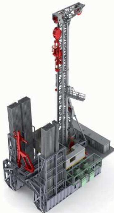
Die vollautomatisierte Tiefbohranlage TBA 440 M2 soll die Gefahren für die Einsatzkräfte minimieren.
