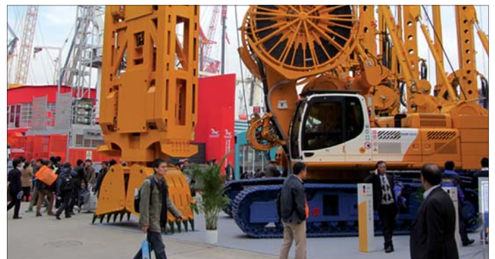
Neuer Greiferträger GB 60 mit hydraulischem Schlitzwandgreifer aus dem Werk Shanghai.
