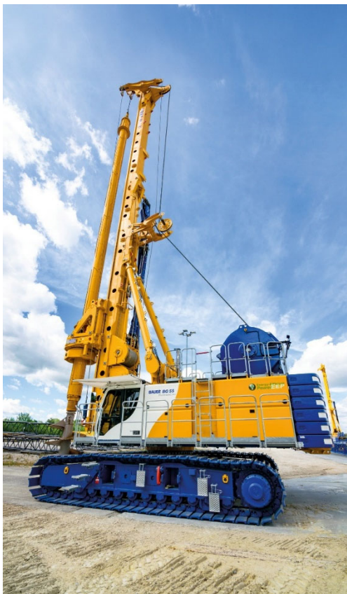
(3) Die BG 55 ist das derzeit größte Drehbohrgerät im Portfolio der BAUER Maschinen GmbH.
