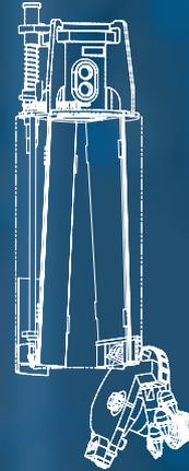
Durch die einzigartige Konstruktion reduziert der **Silent Bucket** die auftretenden Geräusche und den Zeitaufwand beim Entleeren von bindigen, „klebrigen“ Böden aus dem Kastenbohrer. Dadurch wird dieser Vorgang leiser – ein Vorteil nicht nur für die Anwohner, sondern auch für die Mitarbeiter auf der Baustelle.
