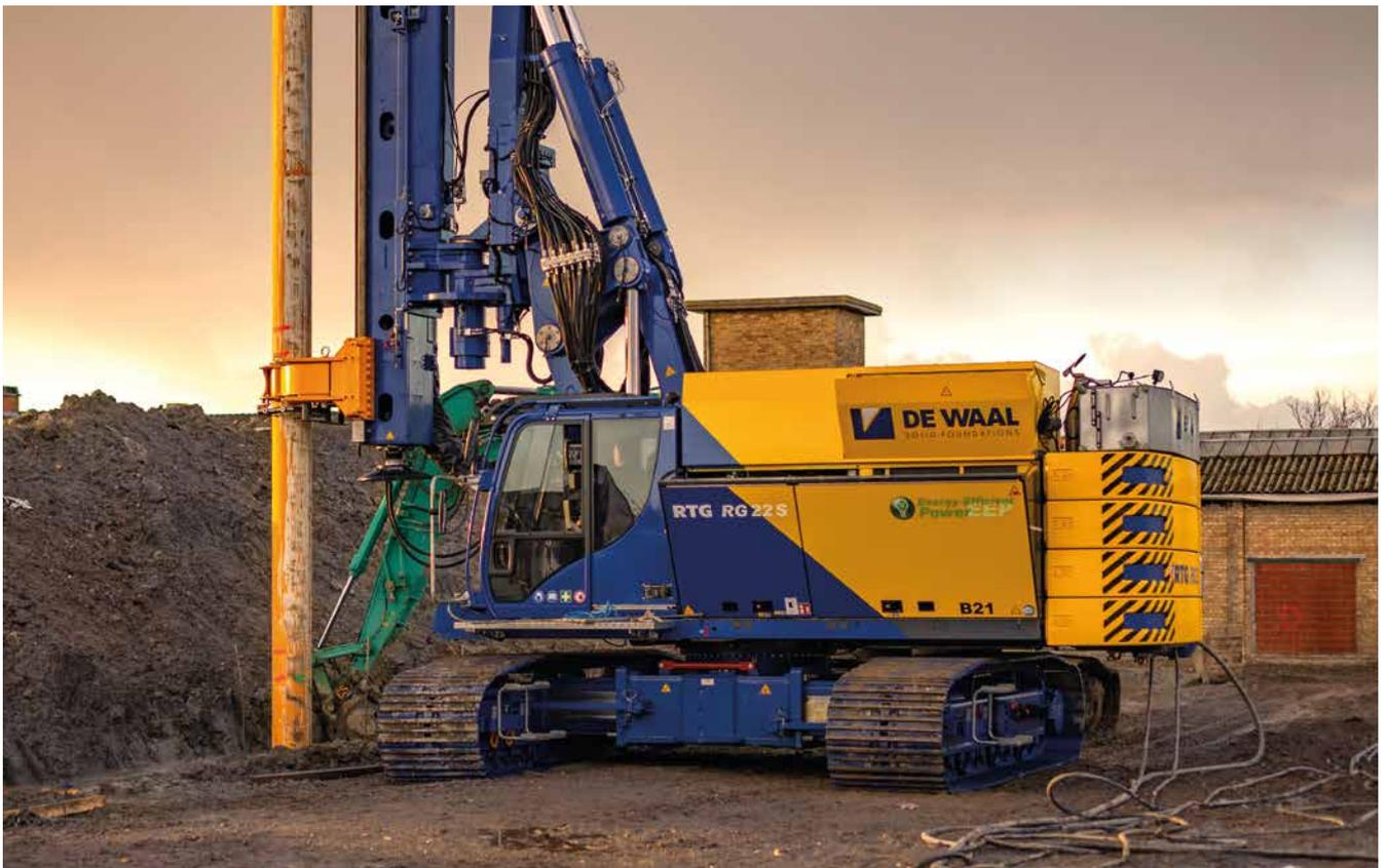
**Belgien** Mit einer brandneuen RG 22 S samt entsprechender Ausrüstung führte De Waal Solid Foundations NV in Nieuwpoort Cutter Soil Mixing-Arbeiten aus.
