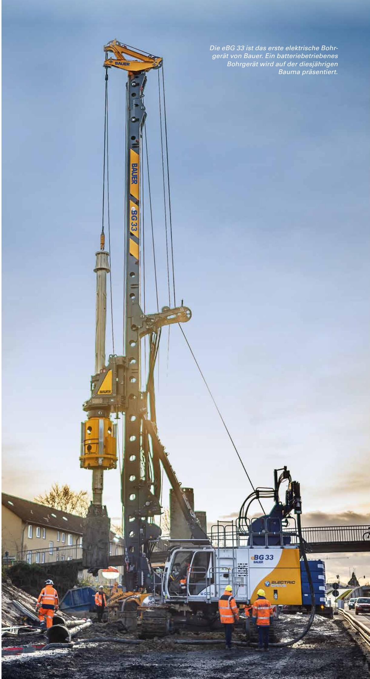
*Die eBG 33 ist das erste elektrische Bohrgerät von Bauer. Ein batteriebetriebenes Bohrgerät wird auf der diesjährigen Bauma präsentiert.*
