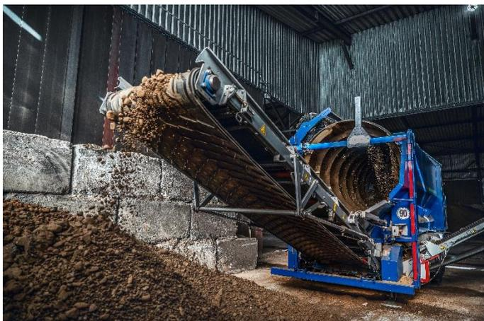
(2) In der 4.500 m<sup>2</sup> großen Behandlungshalle wird das Bodenmaterial mit der brandneuen Trommelsiebanlage aufbereitet. Als Endprodukt entsteht wertvoller Ersatzbaustoff in höchster Qualität.
