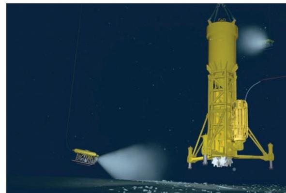
Beim „Vertical Approach“ werden die Schablone und die Schlitzwandfräse über eine Seilwinde abgelassen, anstatt einmal platziert und dann horizontal entlang des Meeresbodens bewegt zu werden.
