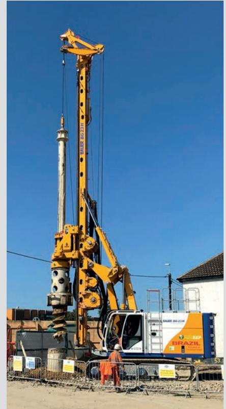
**England** Eine RG 21 T von RTG kam im englischen Tilbury für die Herstellung einer 21 m langen Spundwand durch unseren Kunden Graham Construction Ltd. zum Einsatz. **unten**
