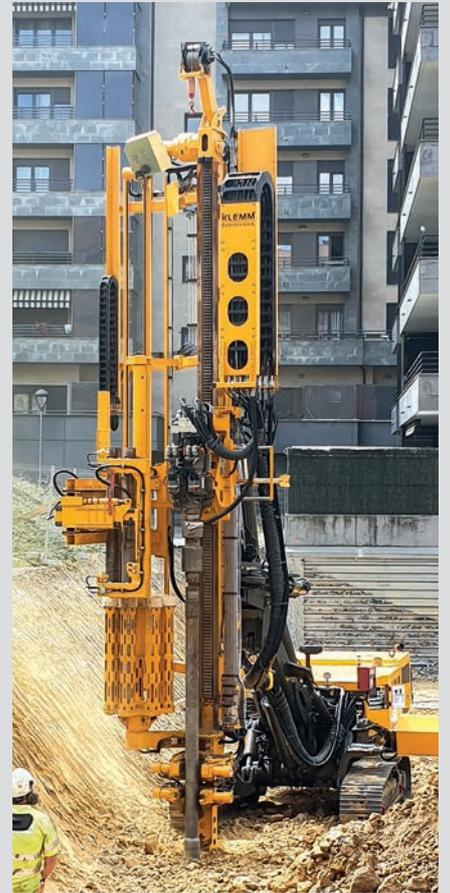
**Spanien** Ein KLEMM-Ankerbohrgerät des Typs KR 806-4GM mit Manipulator und drehbarer Magazintrammel kam in Bilbao bei einem Projekt unseres Kunden Tecimasa S.L.U. zum Einsatz. [oben](#)
