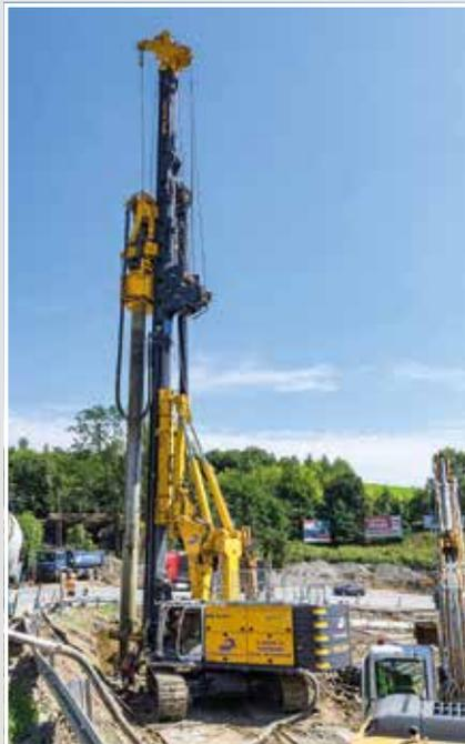
**Österreich** Die Geops Bohrgesellschaft mbH setzte bei einer Entwässerungsbohrung mit Standrohr für einen Tunnelvortrieb auf eine KLEMM KR 805-3G. **oben**
