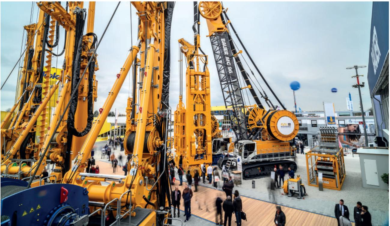
Der 500 kW starke Elektroantrieb des BAUER MC 96 Seilbaggers hat im Vergleich zum Verbrennungsmotor entscheidende Vorteile: Er verursacht keine lokalen Abgase und deutlich weniger Lärm.
