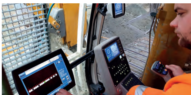
Gerätefahrer mit digitalem Baustellenmodell und daran gekoppelter Aufgabenliste.
