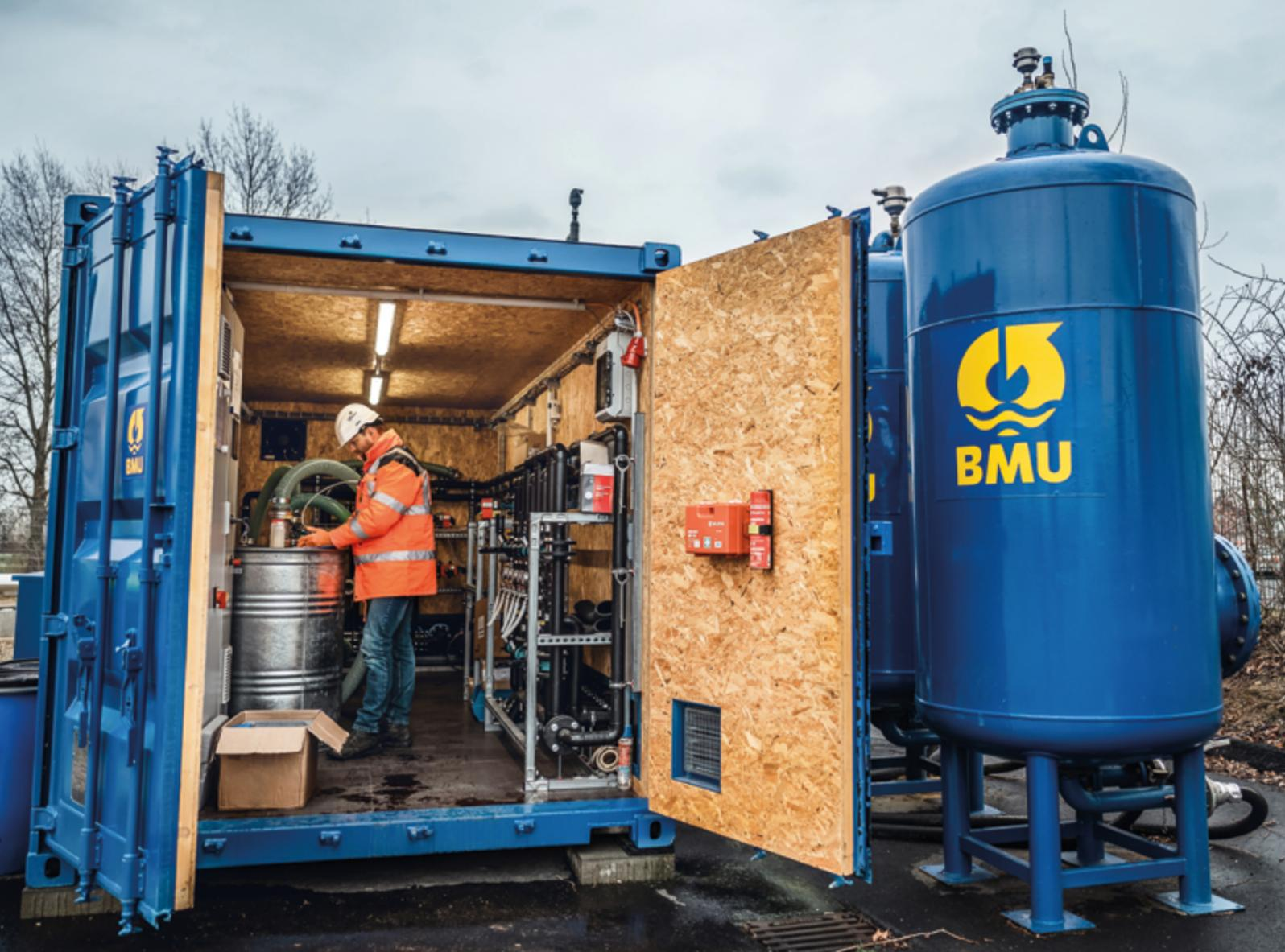
Mittels „Pump-and-treat“-Verfahren reinigt Bauer belastetes Wasser von Schadstoffen wie polyzyklischen aromatischen Kohlenwasserstoffen (PAK), den leichtflüchtigen aromatischen Kohlenwasserstoffen Benzol, Toluol, Ethylbenzol sowie Xylole (BTEX), außerdem Heterocyclen und Cyaniden.
