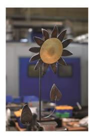
(3) Plasmaschneider, Feile, Kugelhammer und Schweißgerät kamen zum Einsatz.
