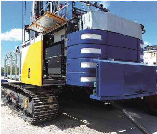
(2) Anstelle des Dieselmotors wurde ein Elektromotor verbaut, die Stromverteilung befindet sich dort, wo eigentlich der Tank ist. Ein Trafo sorgt für die unterschiedlichen Voltspannungen der elektrischen Steuerkomponenten.
