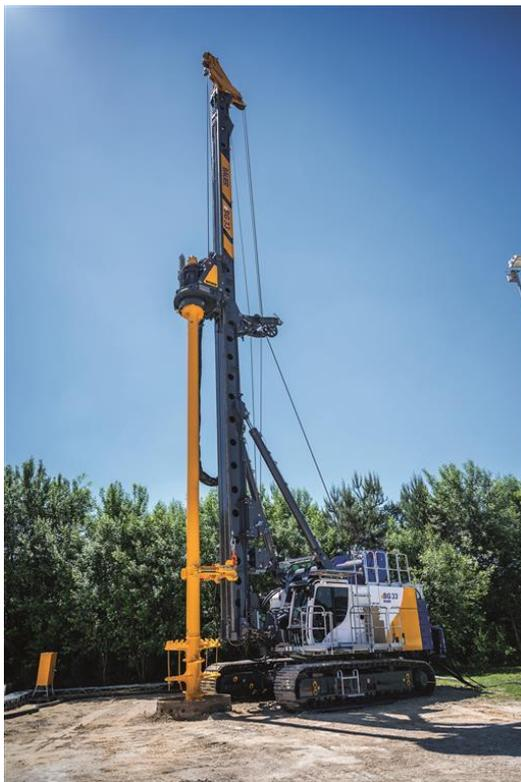
(1) Die neue eBG 33 ist mit mehr als 400 kW Antriebsleistung im mittleren Segment der Bohrgerätereihe angesiedelt.
