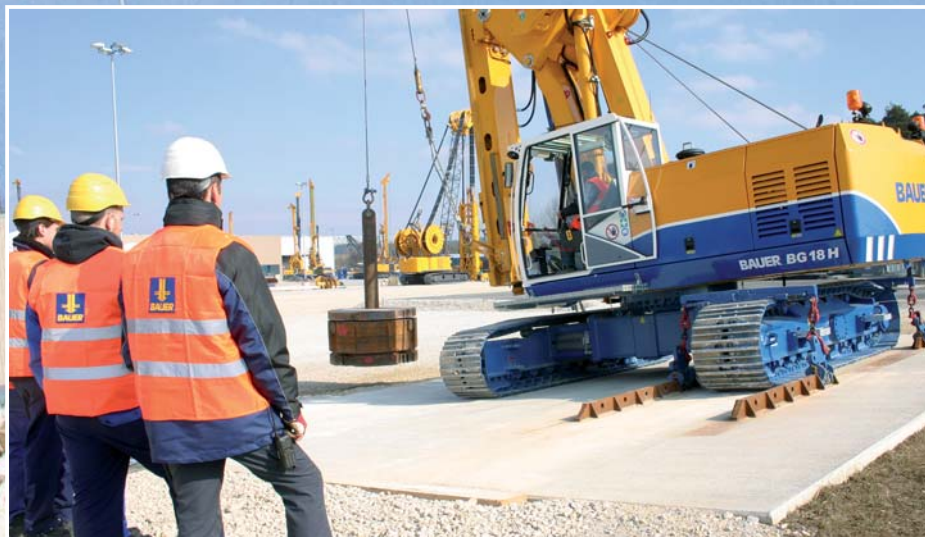
Geübt wird auch – mit Gerät in Transportstellung – die Auffahrt auf den Tieflader. An der Kante kippt das Gerät ...
