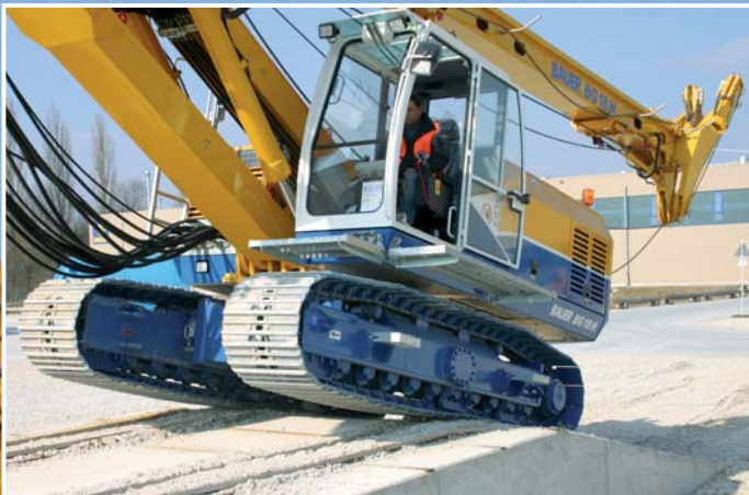
Geübt wird auch – mit Gerät in Transportstellung – die Auffahrt auf den Tieflader. An der Kante kippt das Gerät ...
