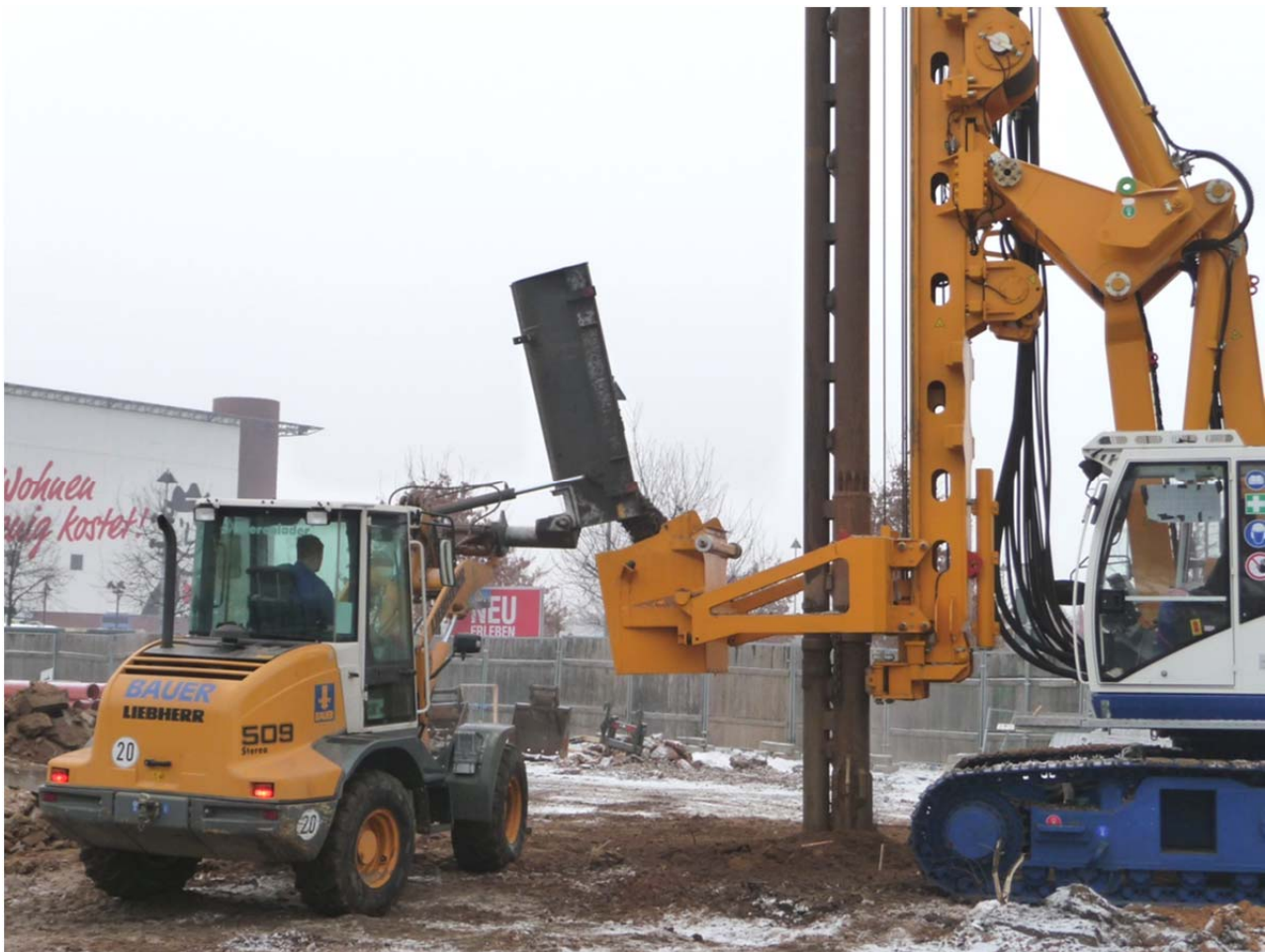
Abb. 20: Radlader mit Seitenkippschaufel
